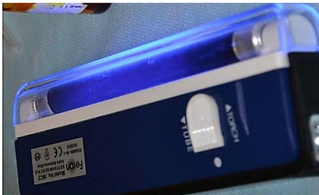
Рис. 1. Ультрафиолетовый излучатель с излучением синего спектра света.
